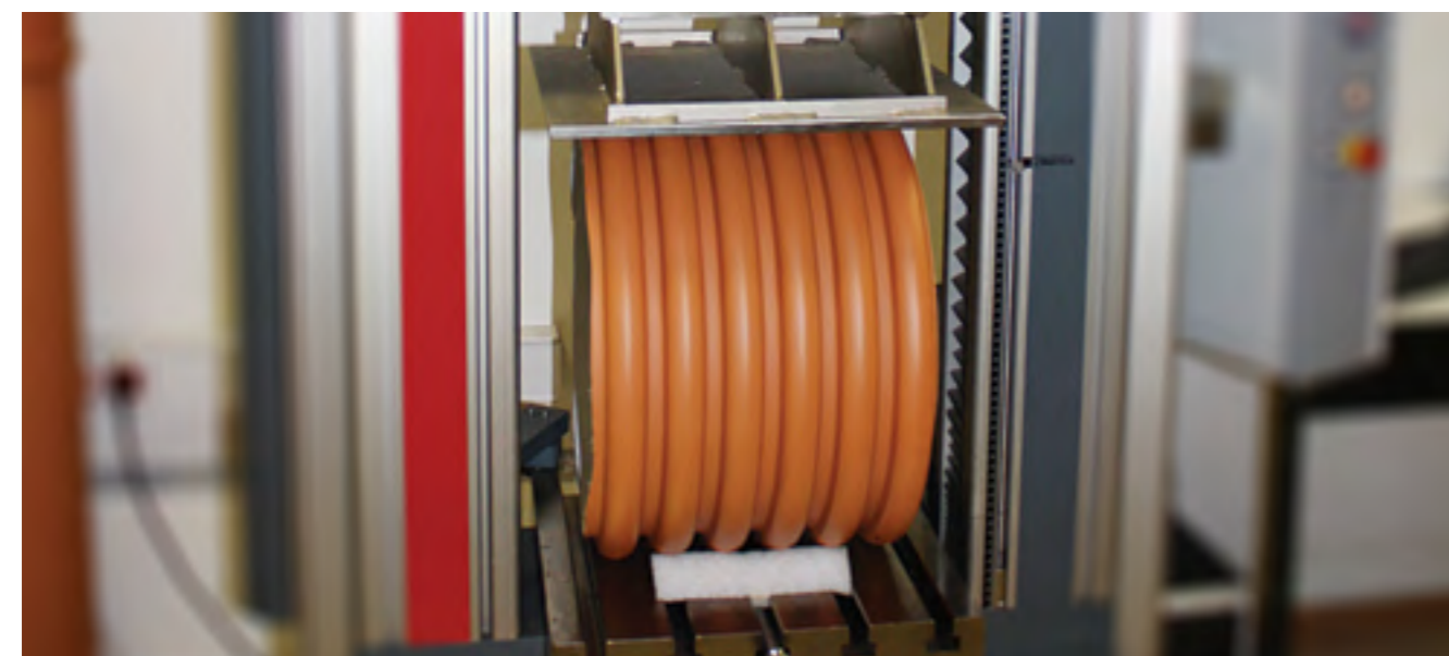
лабораторные испытания трубы Polytron ProKan
